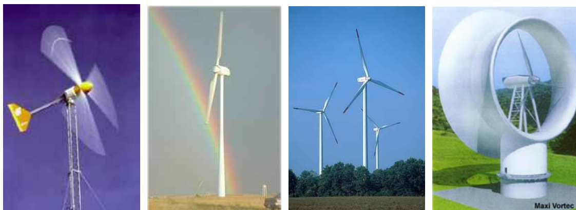
Rys. 6. Przykłady siłowni wiatrowych z poziomą osią obrotu: a) mała przydomowa elektrownia wiatrowa o mocy 10 kW BWC Excel [ http://www.bergey.com ], b) wirnik z dwoma łopatomy [ http://www.windturbinecompany.com ], c) turbiny wiatrowe GE Power na farmie wiatrowej Walchum, Niemcy [ http://www.gepower.com ], d) turbina wiatrowa firmy Vortec z dyfuzorem DAWT
