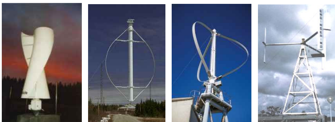
Rys. 7. Przykłady siłowni wiatrowych z pionową osią obrotu: a) zmodyfikowany wirnik Savoniusa [ http://www.windside.com ], b) elektrownia wiatrowa o mocy 4MW z wirnikiem Darrieusa – Quebec [ http://www.wind-works.org ], c) zmodyfikowany wirnik Darrieusa – Francja [ http://www.wind-works.org ], d) wirnik typu H-Darrieus
