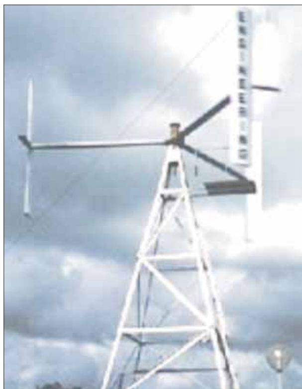
Rys. 7. Przykłady siłowni wiatrowych z pionową osią obrotu: a) zmodyfikowany wirnik Savoniusa [ http://www.windside.com ], b) elektrownia wiatrowa o mocy 4MW z wirnikiem Darrieusa – Quebec [ http://www.wind-works.org ], c) zmodyfikowany wirnik Darrieusa – Francja [ http://www.wind-works.org ], d) wirnik typu H-Darrieus
