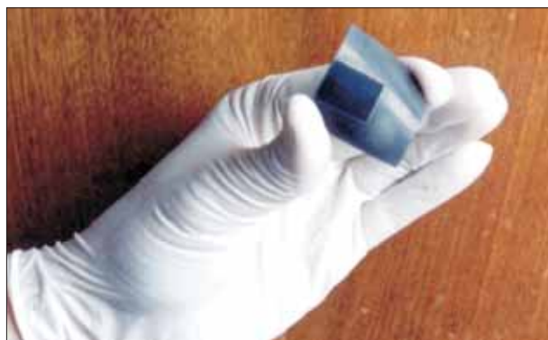
Fot 5. Polikrystaliczna warstwa półprzewodnikowa CdTe (telluru kadmu) na elastycznej folii molibdenowej [Sibiński 2004]
